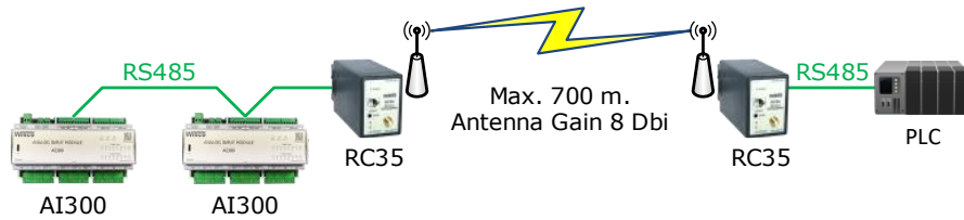
การเชื่อมต่อผ่านระบบไร้สาย (Wireless Point to Point: RC35)
